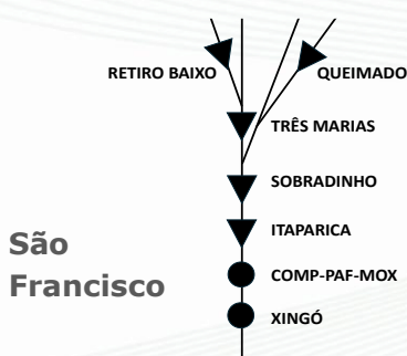
Figura 6.45 Exemplo – sistema hidrotérmico em cascata
