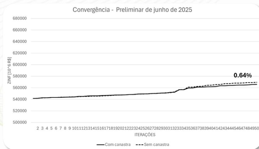
Figura 6.40 Evolução do ZINF nos casos Com e Sem Canastra, com ambos os casos executados com 50 iterações com a versão 31_centos
